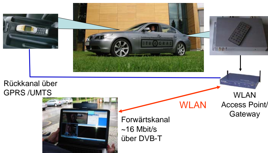
Abbildung 38: DVB-T Infrastruktur im Testfahrzeug
