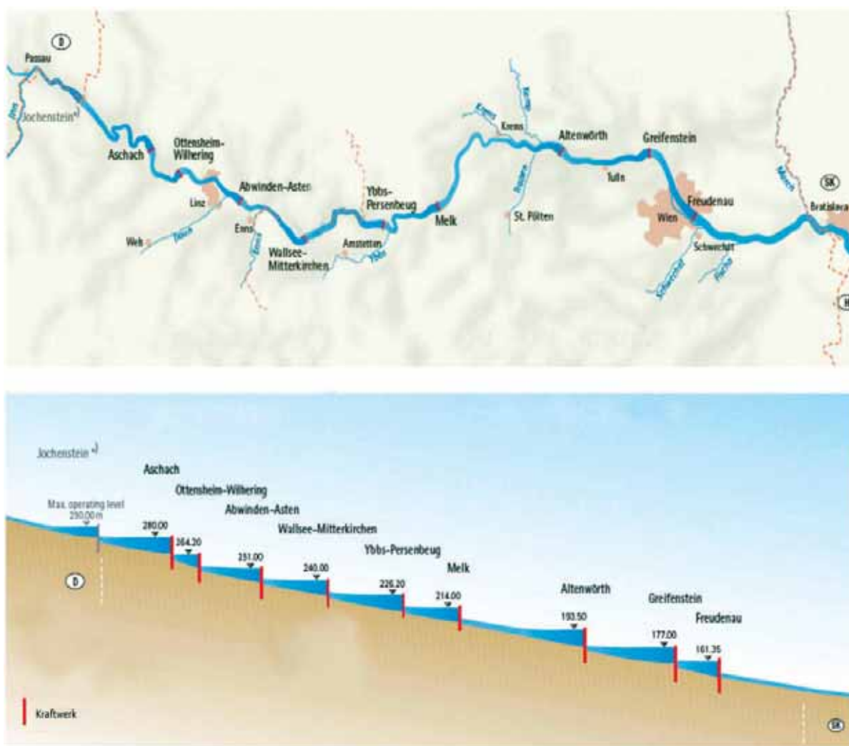
Abbildung 1: Kraftwerke an der österreichischen Donau
