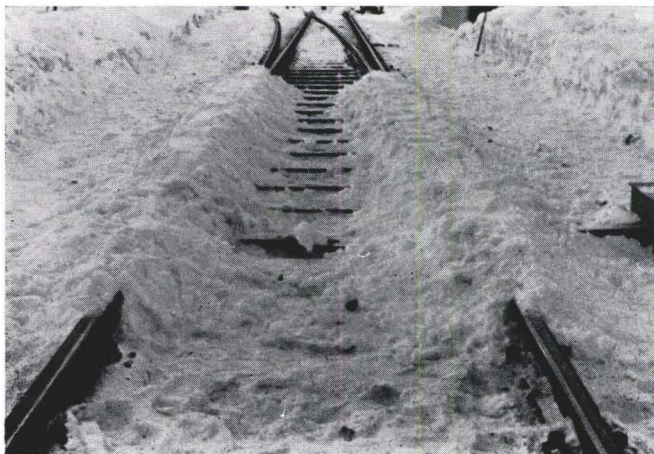
Abb. 9: Versuch Bahnhof Seefeld in Tirol. Mit Schnee verfüllte Weiche mit elektrischer Heizung, System ELTRA
