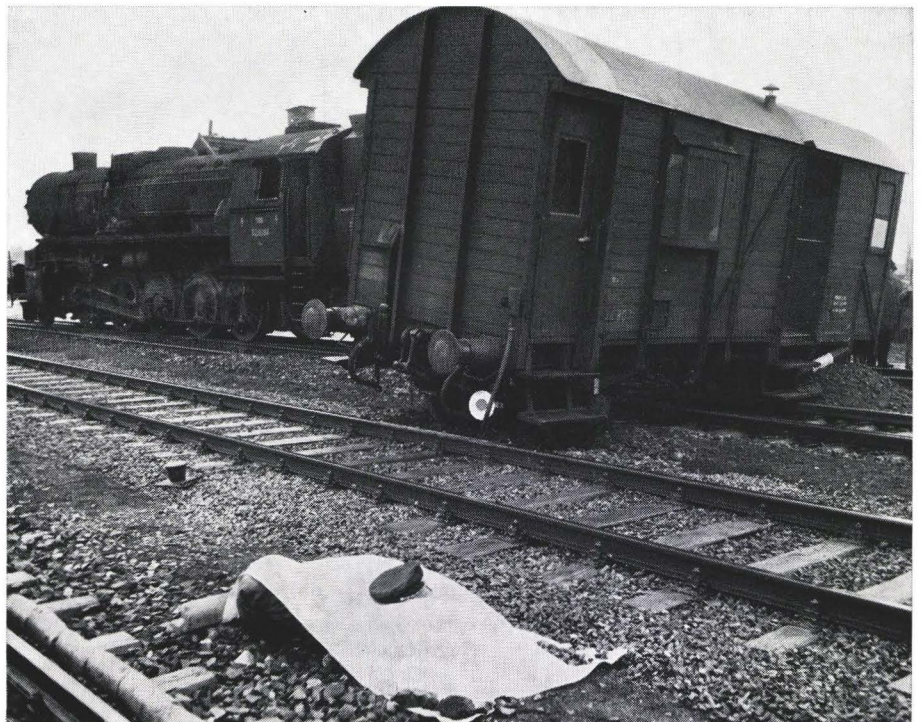
Abb. 13: Tödlicher Unfall eines Schaffners bei einer Verschieb-entgleisung (Zu Abschnitt IV/1, Unfall 3)
