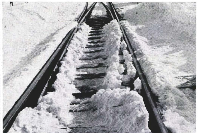
Abb. 10: Versuch Bahnhof Seefeld in Tirol. Wirkung der elektrischen Weichenheizung, System ELTRA
