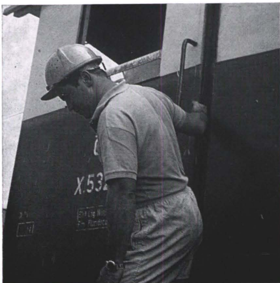
Abb. 16: Unfallgefährliches, unvorschriftsmäßiges Absteigen vom Motorturmwagen (Gefahr von Fuß- und Handverletzungen) (Siehe auch Abschnitt IV/3)
