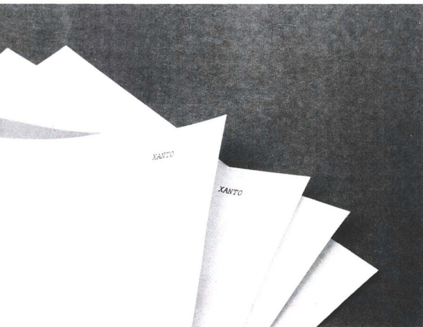
Thermosensibles Papier wird für thermische Druckwerke, wie Rechenmaschine, Printer u. ä., eingesetzt. Das Blatt oder die Papierrolle wird mit einer vorerst farblosen Schicht überzogen, in der dann durch Wärmeentwicklung eine chemische Reaktion der Farbbilder ausgelöst und das Zeichen sichtbar gemacht wird.
