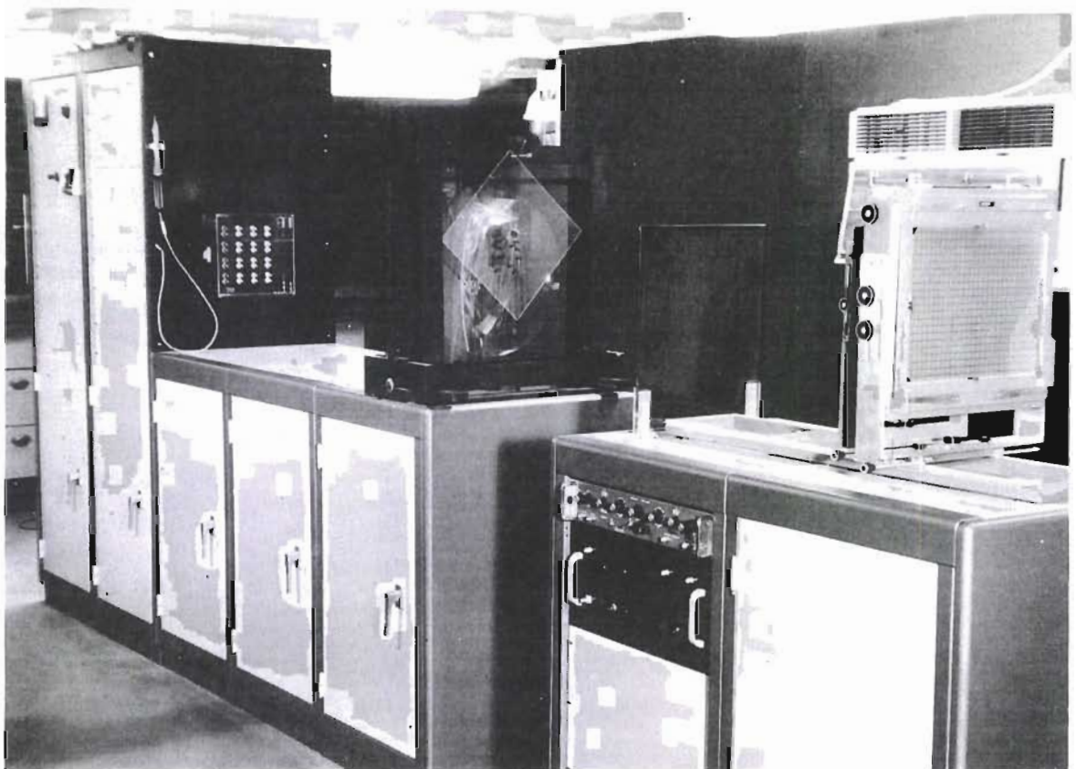
CRANZ-SCHARDIN-Hochgeschwindigkeitskinematographie-Anlage für dynamische spannungsoptische Untersuchungen zur Aufzeichnung schneller Bewegungsvorgänge z. B. Rißausbreitung und Wellenausbreitungsphänomene in ebenen transparenten und nichttransparenten Modellen aus Glas, Kunststoffen, Beton, Fels, metallischen und nichtmetallischen Werkstoffen. Bildfrequenzbereich: 20.000—2.000.000 Bilder pro Sekunde (Parkus—Rossmann, TU Wien).
