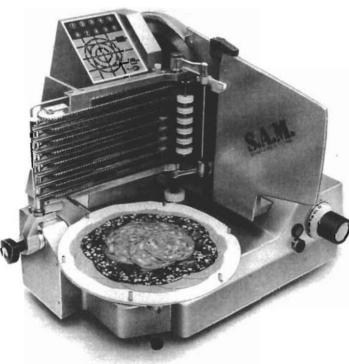
Diese elektronisch gesteuerte **Lebensmittel-Schneide- und Ablegemaschine** gestattet mit der Mikroprozessorsteuerung des Ablegers wahlweises Stapeln, Quer- oder Längsreihen des Schnittgutes. Auch das Belegen von Rundtellern ist möglich, sodaß das Schnittgut serviergerecht präsentiert wird. Die Eingabe erfolgt über eine Sensor-Tastatur, die auf „Streicheln“ reagiert und die gewählte Ablegeform und Scheibenanzahl anzeigt.
