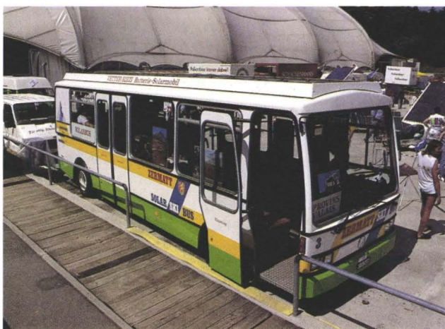
Die Weiterentwicklung der Batterietechnik und von photovoltaischen Zellen zur Gewinnung von Elektrizität aus Sonnenenergie eröffnet neue Perspektiven für den Einsatz von Elektro-Kfz: Elektro-Skibus in Zermatt mit photovoltaischen Zellen am Dach. Die daraus gewonnene Sonnenenergie ergänzt den Batteriestrom.
