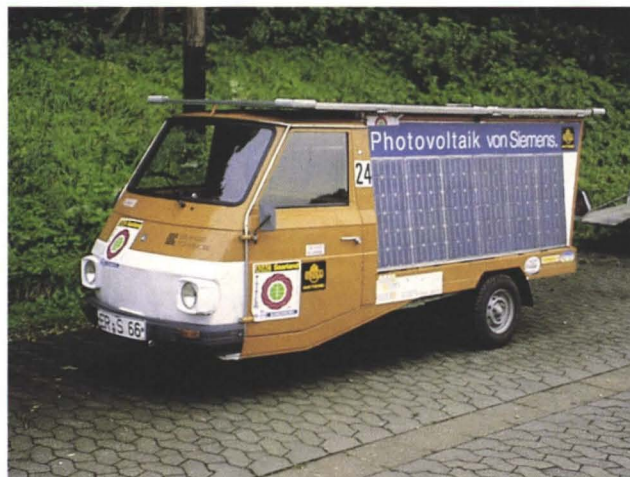
Elektrisch betriebene Nutzfahrzeuge sollen in Zukunft einen erheblichen Teil des Güternahverkehrs übernehmen. Prototyp eines Klein-LKW mit Solarzellen zur Unterstützung der Batterie.
