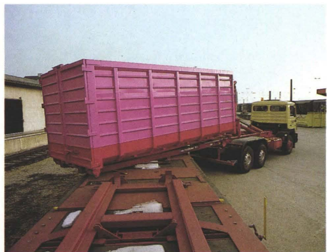
Road-Railer, die derzeit von den europäischen Bahnen erprobt werden, ermöglichen die Verwendung eines Transportgefäßes für Straße und Schiene (siehe Abbildung im Kapitel 4.1). Abrollcontainer ermöglichen die Ver- und Umladung von Containern ohne Kran.
