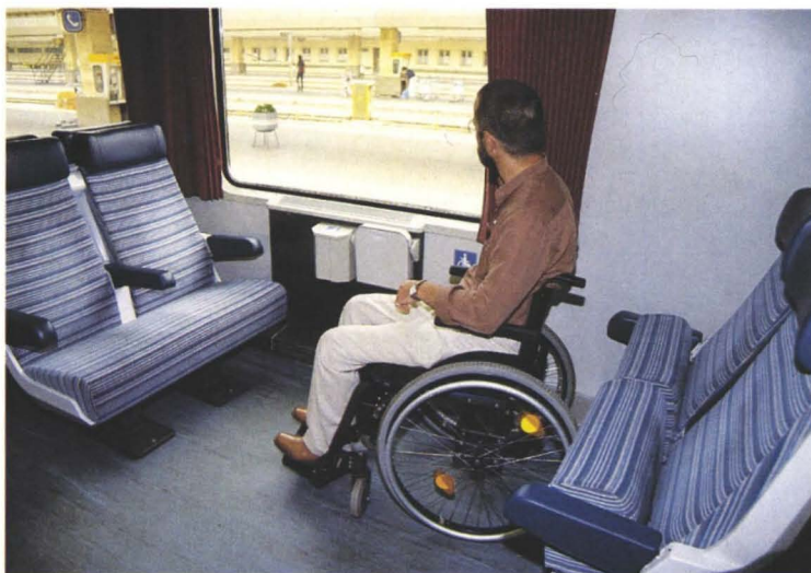
Behindertenabteil in modernen ÖBB-Reisezugwagen, auch Gänge, Türen und die Toiletten sind für Menschen mit Rollstühlen geeignet.
