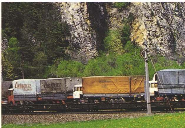
Die Rollende Landstraße (begleiteter kombinierter Verkehr) ist als Übergangslösung - vor allem für kleinere Transportunternehmen mit einfacher Transportlogistik - zu sehen. Längerfristig sind Formen des effizienteren unbegleiteten kombinierten Verkehrs (Container, Wechselaufbauten u. a.) zu forcieren und die logistischen Lösungen, auch für kleine Unternehmen, zu verbessern.
