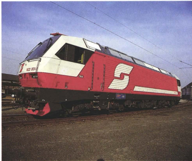
Die Elektrolok der Baureihe 1822 ist auch für das italienische Gleichstromnetz geeignet. Dadurch können Lokwechselaufenthalte an den Grenzen entfallen.
