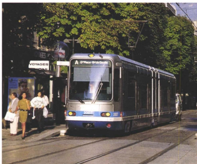
Benutzerfreundliche Niederflurstraßenbahn in Grenoble. Von bei Haltestellen erhöhter Gehsteigen ist stufenloses Einsteigen möglich. Der private Autoverkehr wird in dieser Straße zur Bevorrangung der Straßenbahn beschränkt.
