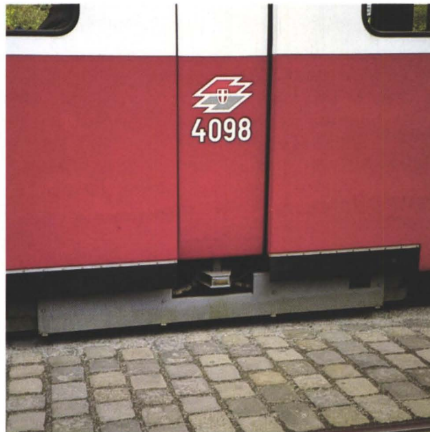
Lärmschutz bei Straßenbahndrehgestell.
