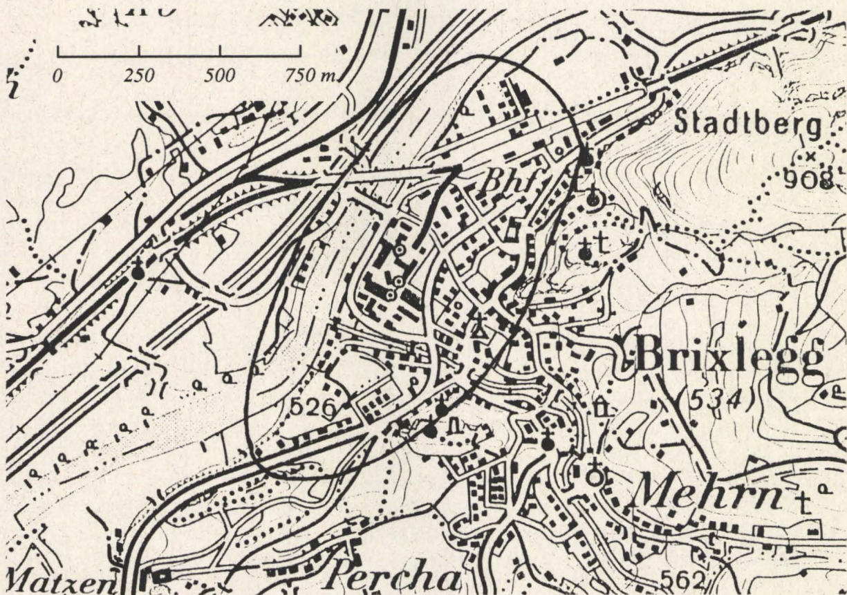
Abb. 3: Zone in der Umgebung der Kupferhütte Brixlegg, in der aufgrund der Bodenbelastungen mit Metallen die Einschränkung landwirtschaftlicher u. gärtnerischer Nutzungen sowie Sanierungs- bzw. Vorsichtsmaßnahmen empfohlen wurden
