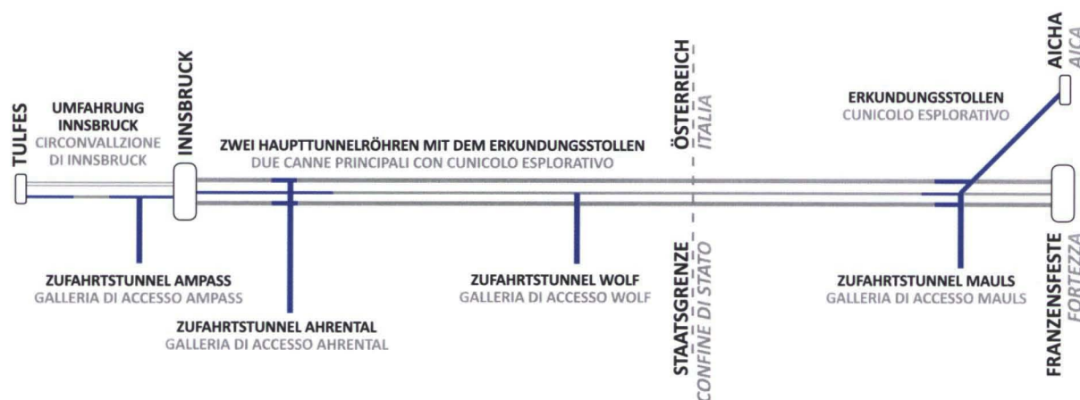
Abbildung 3: Stand der Baumaßnahmen am Brenner Basistunnel, Juli 2015
