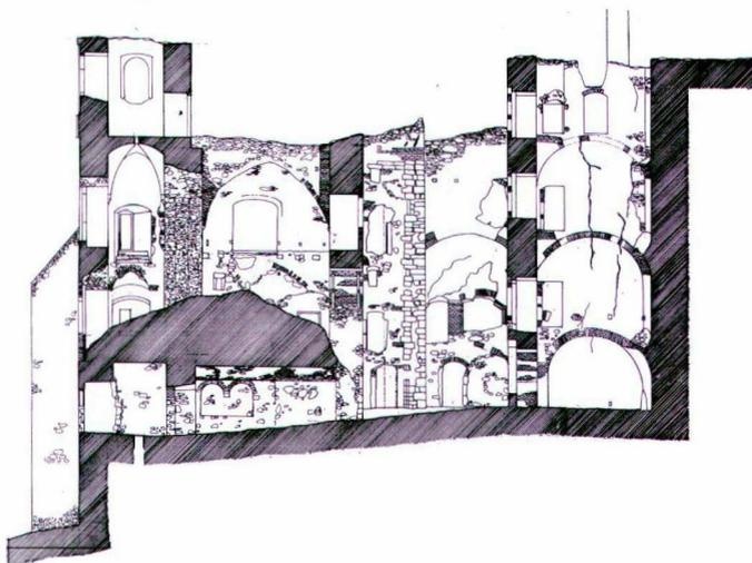
Abb. 1: Landsee, Burgenland, Burgruine; Bauaufnahme; Längsschnitt durch den mittelalterlichen Kern
