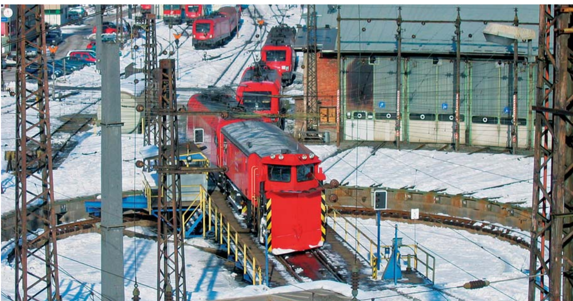
Wesentlich für die Betriebsqualität im Winter: Schneeflug auf der Drehscheibe in Innsbruck
