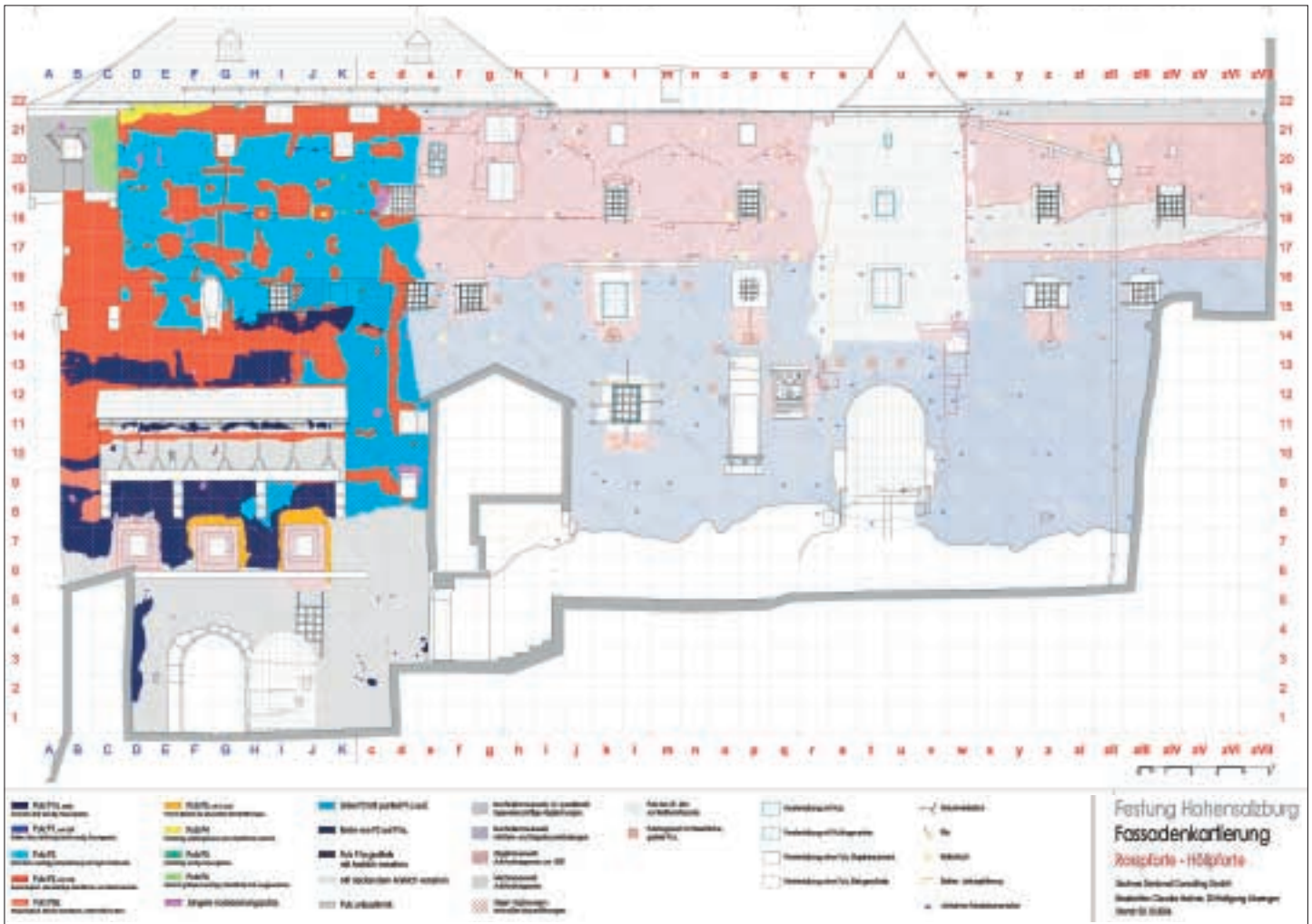
Abb. 3: Salzburg, Festung, Fassadenkartierung
