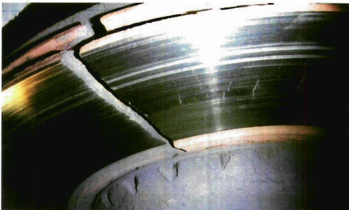
Gefahr im Verzug: gebrochene Bremsscheibe
