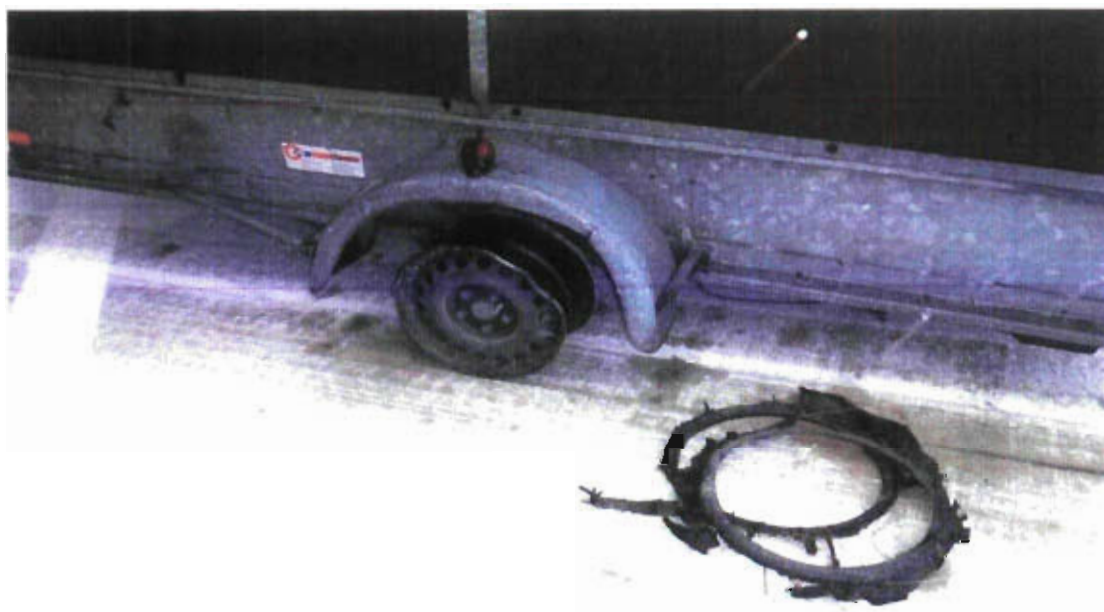
Gefahr im Verzug: abgelöster Reifen
