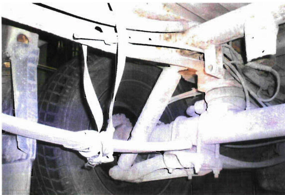
Gefahr im Verzug: gebrochenes Federblatt
