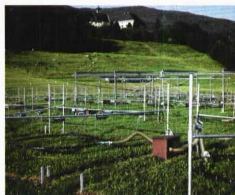
Im Klimamanipulationsexperiment „Clim Grass“ der Forschungsanstalt Raumberg-Gumpenstein werden Auswirkungen von Klimawandel auf Grünland untersucht.
