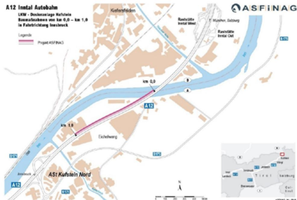
Im Detail wurden, im Zeitraum von Mitte Oktober 2019 bis Mitte Februar 2020, fünf neue Anzeigequerschnitten, ausgestattet mit LED-Wechselverkehrszeichen und vollgrafischen LED-Anzeigen, sowie eine Dosierampel errichtet. Ein bestehender VBA-Anzeigequerschnitt wurde adaptiert. Die gesamte Anlage wird über den VBA-Arbeitsplatz der regionalen Verkehrsmanagementzentrale St. Jakob gesteuert.
