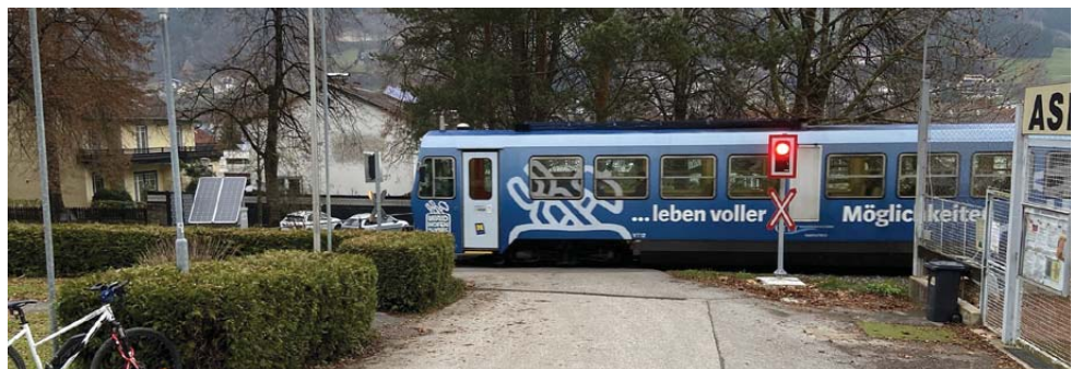
Abbildung 9: Vereinfachte Technische Sicherungsanlage (VTS) in Waidhofen/Ybbs © AIT/Aleksa
