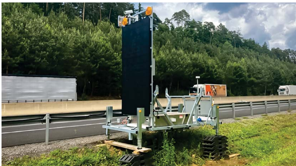
Abbildung 22: Stationäre IMIS-Anhebtafel – Aufstellung an Böschung © ASFINAG
