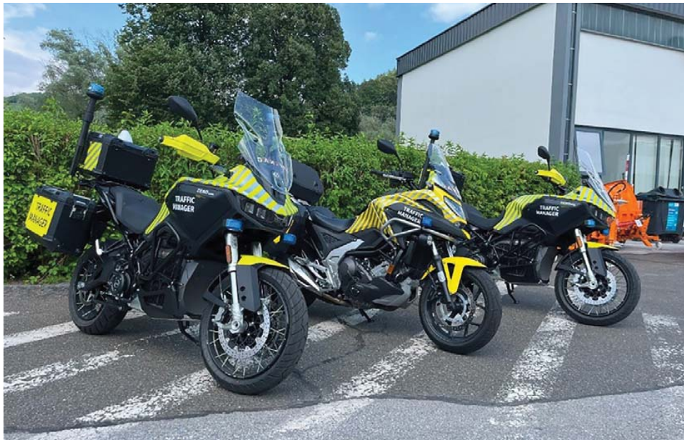
Abbildung 18: Mit C-ITS ausgestattete Traffic- Manager-Motorräder © ASFINAG
