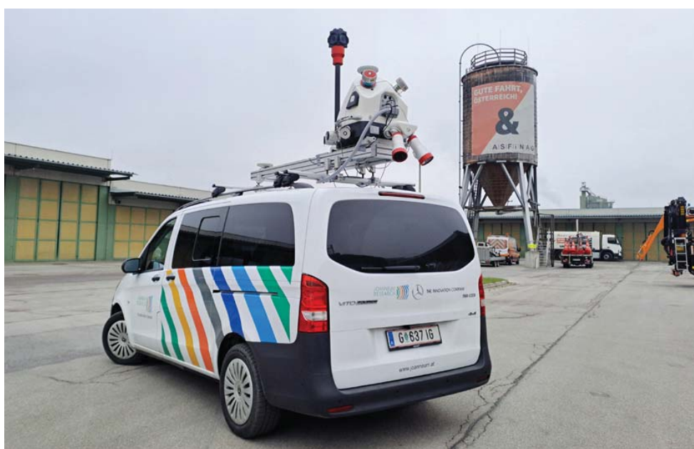
Abbildung 3: Messfahrzeug des Digital Twin Labs zur hochgenauen skalierbaren 3D-Vermessung der Fahrbahnoberfläche und der Umgebung als Basis für die Ableitung von digitalen Zwillingen © JOANNEUM RESEARCH
