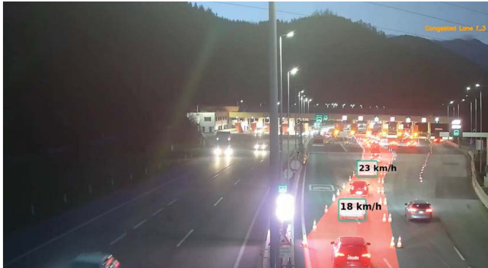
Abbildung 15: HighScene detektiert eine verstopfte Spur während einer Spurführung im Baustellenbereich an der Mautstelle Gleinalm © ASFINAG
