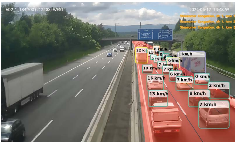
Abbildung 20: Kamerabild mit Fahrzeugpositionen und Stauspuren aus HighScene annotiert © ASFINAG
