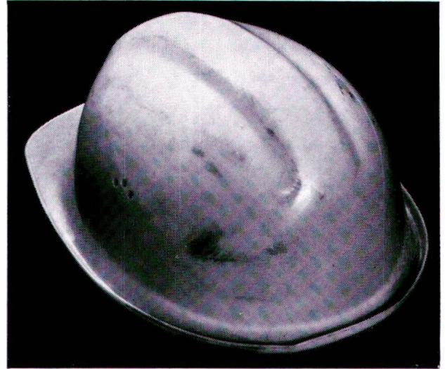
Abbildung 10: Bei Vershubtätigkeit wurde der Träger dieses Schutzhelmes mit dem Kopf gegen einen Lichtmast geschleudert und nur leicht verletzt. Auch der Schutzhelm (siehe Abbildung) wurde nur geringfügig beschädigt (zu Abschnitt IV/3, Fußnote 1, bzw. Unfall Nr. 57).
