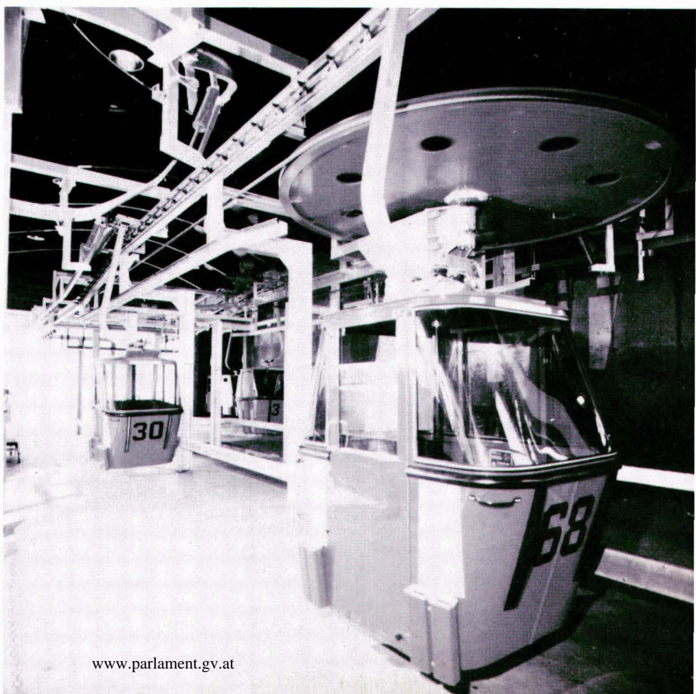
Bild 16 Einseilumlaufbahn. Station mit automatischer Wagentransporteinrichtung.
