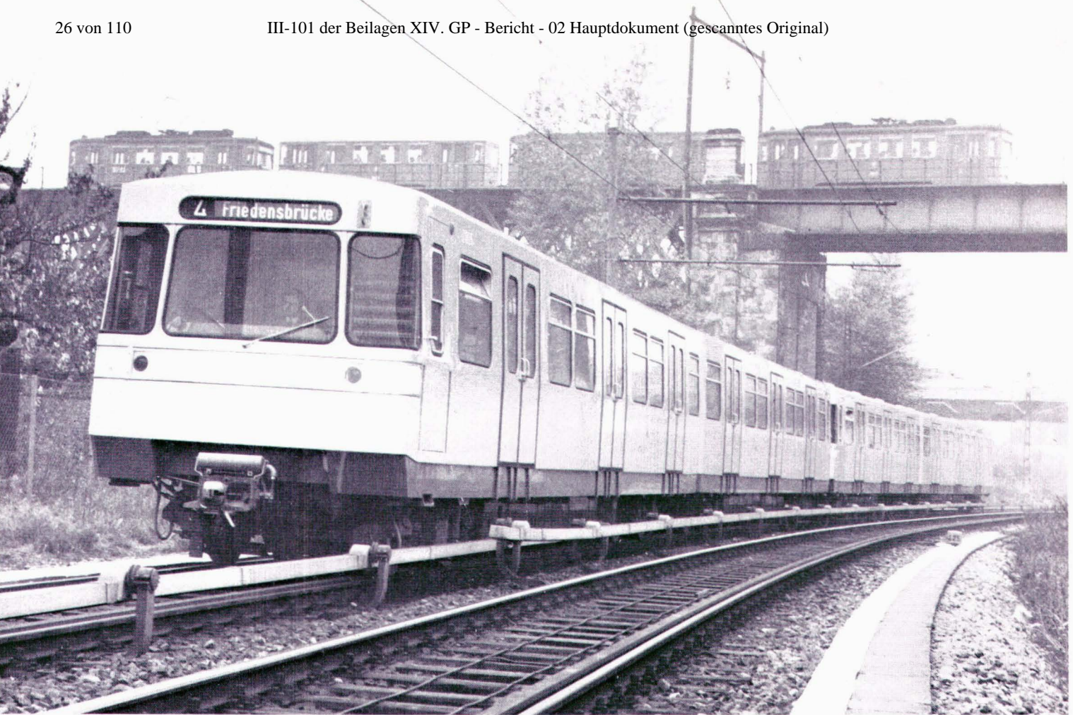
▲ Bild 13 Zug der Wiener U-Bahn. Auf der Brücke quert gerade ein Zug der Wiener Stadtbahn die Trasse der U-Bahn. Die bei der U-Bahn als Fahrleitung verwendete Stromschiene bedingt entsprechende Isoliermaßnahmen. ▼ Bild 14
