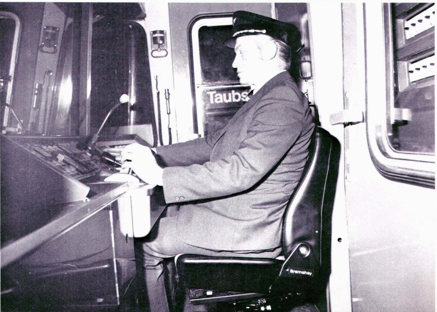
Bei den Triebfahrzeugen der Wiener U-Bahn wurde auch der Einfluß einer ergonomischen Führerstandsgestaltung entsprechend berücksichtigt.
