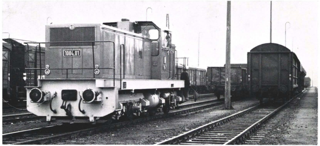
Abb. 13: Eine der neuen 1000-PS-Werkslokomotiven im Einsatz am Mühlbachbahnhof
