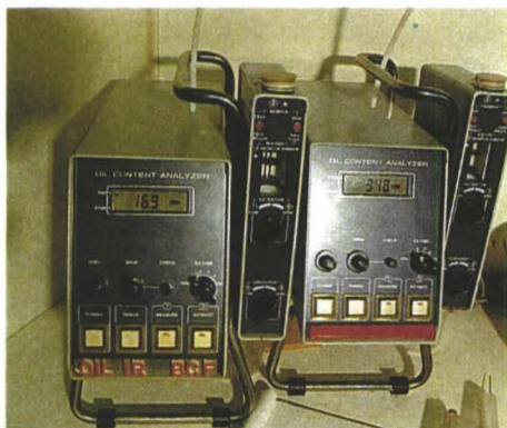
Zur Kohlenwasserstoff-Restwertbestimmung werden diese transportablen Infrarot-Geräte eingesetzt
