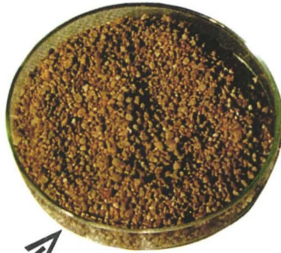
Die BCF-Aktivgranulateilchen können Öl fest an sich binden und Industrieabwässer reinigen
