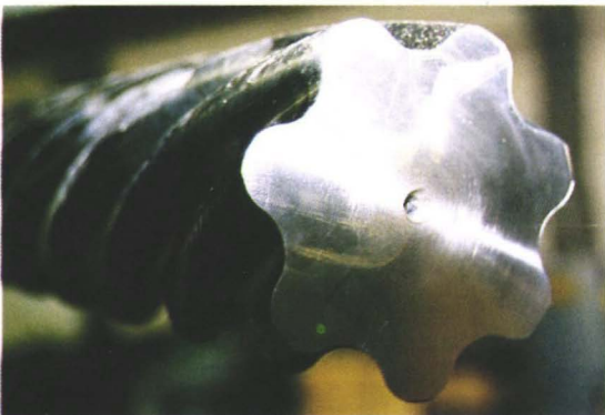
Ein Rotor in Großaufnahme, Form und Oberfläche dürfen nur maximal 20 Mikrometer von der Vorgabe abweichen — das sind 20 Millionstel Meter
