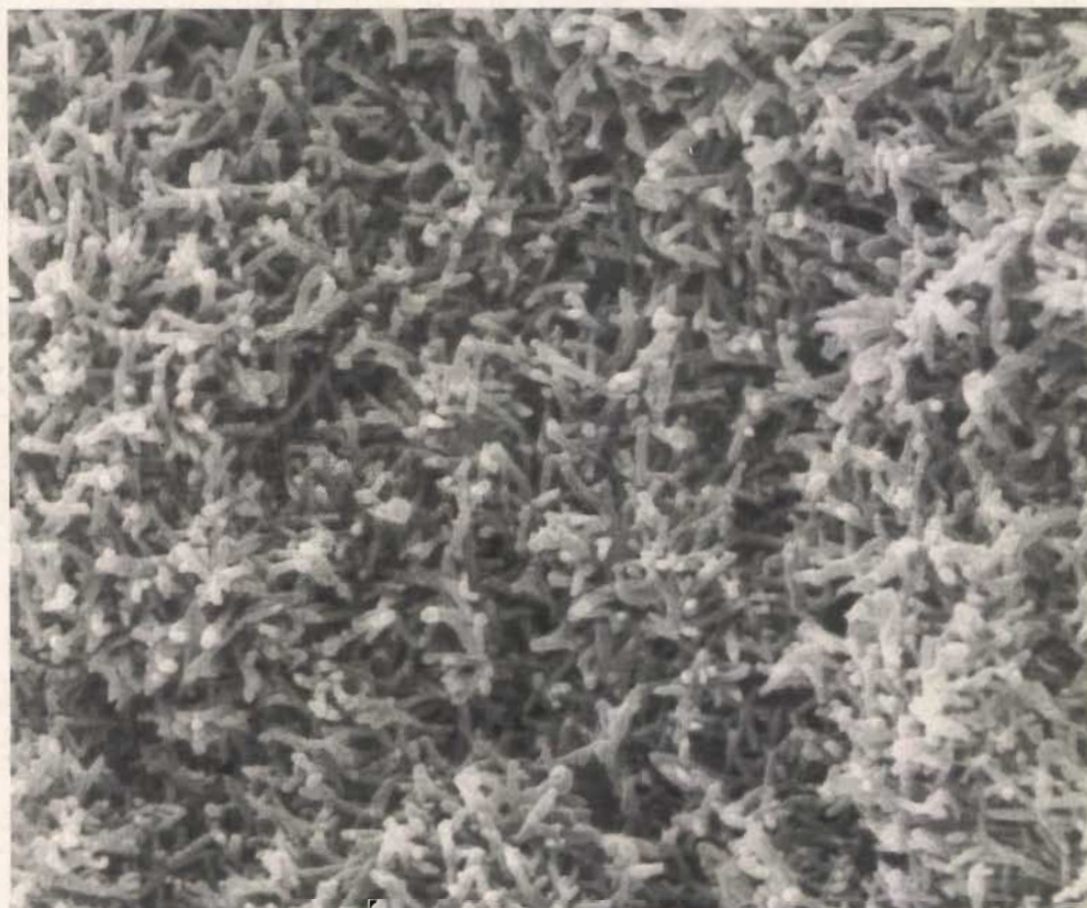
Abb. 10: REM-Photo von intaktem, d.h. röhrenförmig strukturiertem Nadelwachs. Vergrößerung 7.500fach
