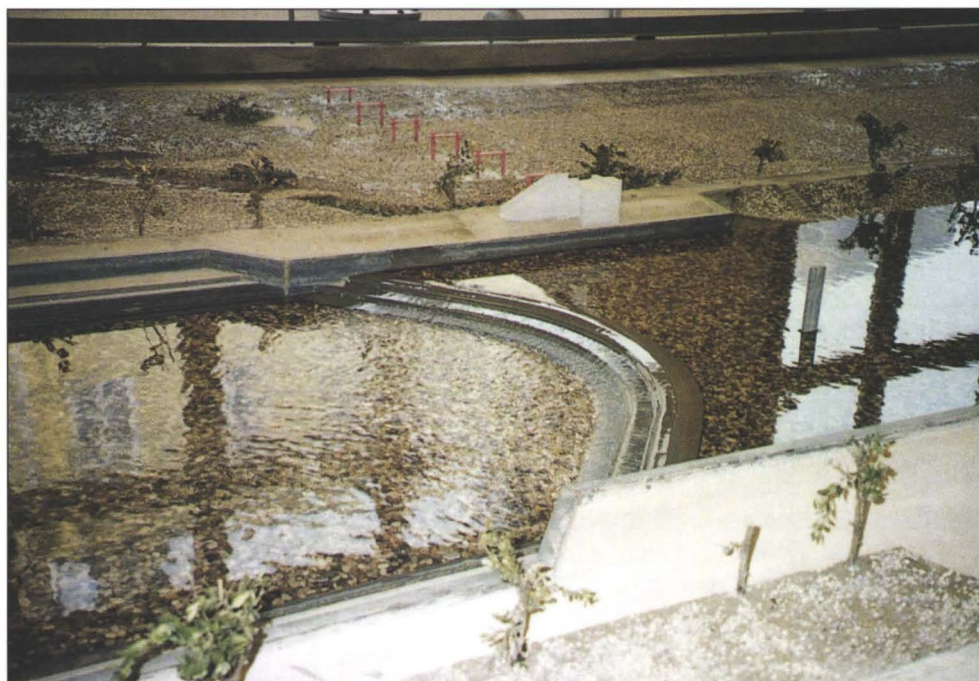
Abb.10.3: Modellversuch Traisen bei St.Pölten
