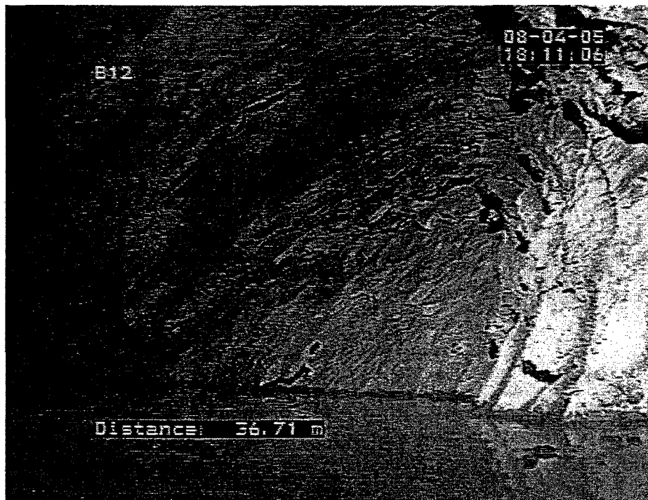
Abb. 10: Bohrung 12: Bergbauhohlraum: Unter Wasser stehende Sohle mit erkennbaren Spiegelstandsänderungen; Einfallen der Schichtung gegen NW
