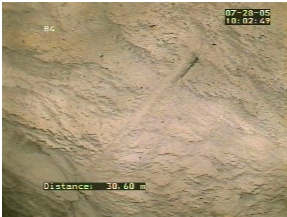
Abb. 6: Schusspfeife im Hohlraum der Bohrung 4
