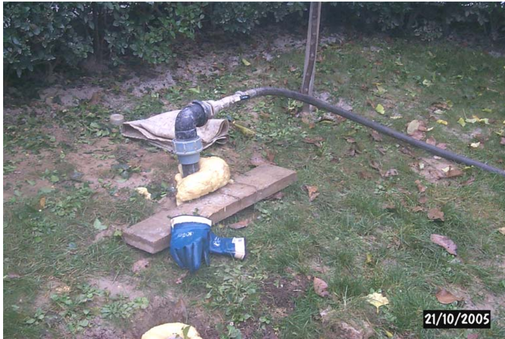
Abb. 17: Druckluftaufgabe über Bohrung 12
