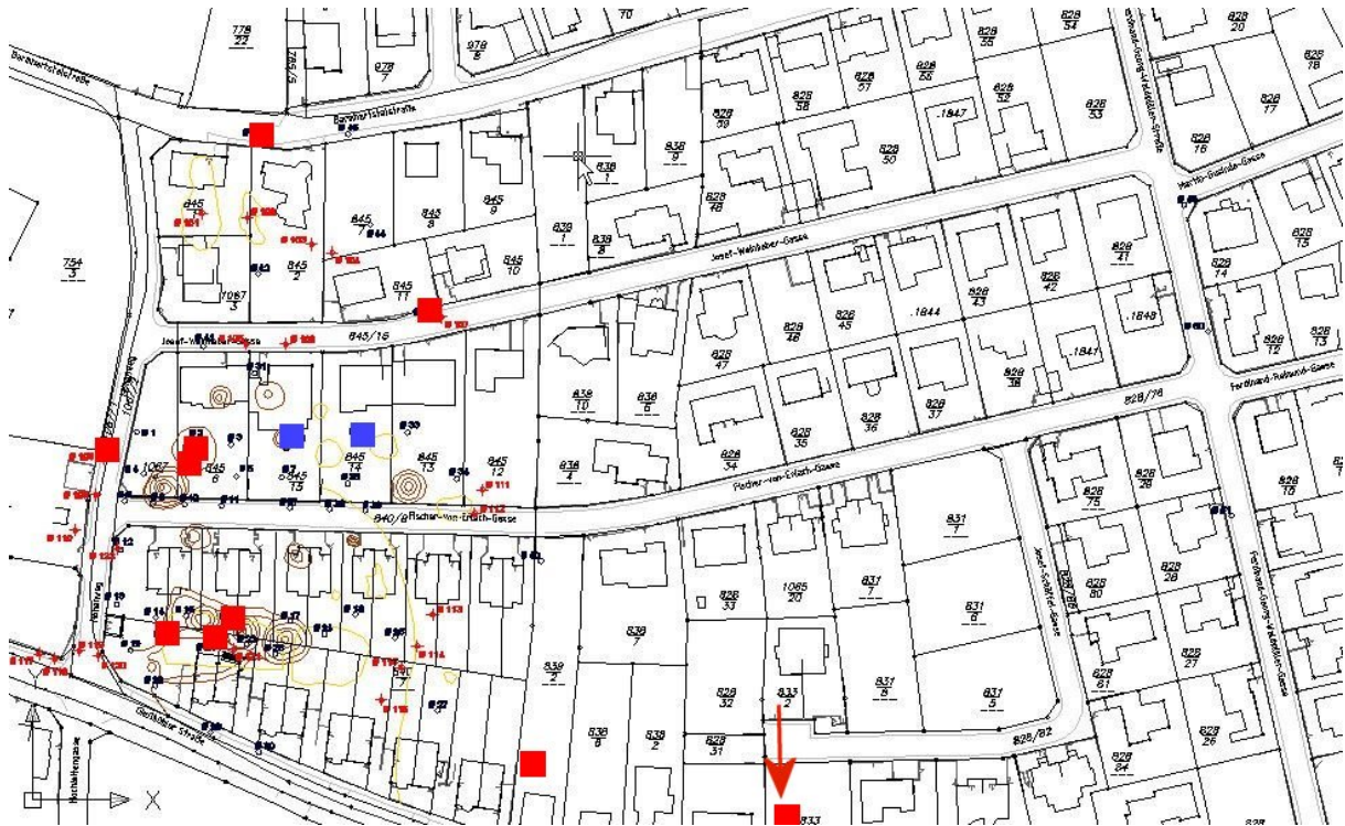
Abb. 16: Lagemäßige Darstellung der Bereiche mit kritischen Restschwebenmchtigkeiten (rot) bzw. Hohlräumen über der Gipsoberkante (blau) Pfeil markiert einen Hohlraum außerhalb des Kartenausschnittes
