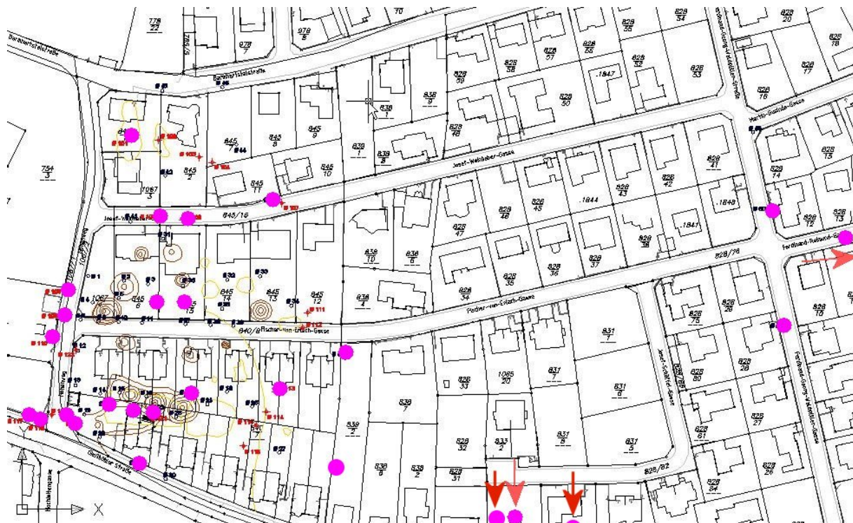
Abb. 3: Verbreitung breiig weicher Sedimente über der Gipsoberkante Pfeile: Die jeweiligen Messpunkte liegen außerhalb des Bildausschnittes
