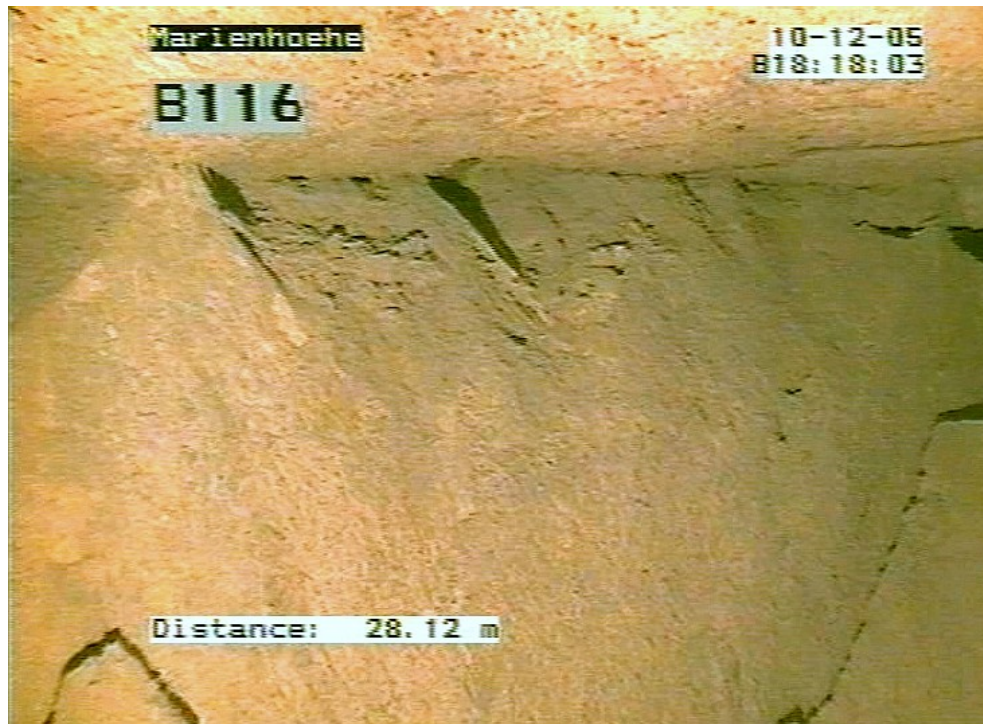
Abb. 7: Resthohlraum; Aus der Form des firstbündigen Schuttkegels kann auf eine Veratztätigkeit rückgeschlossen werden.
