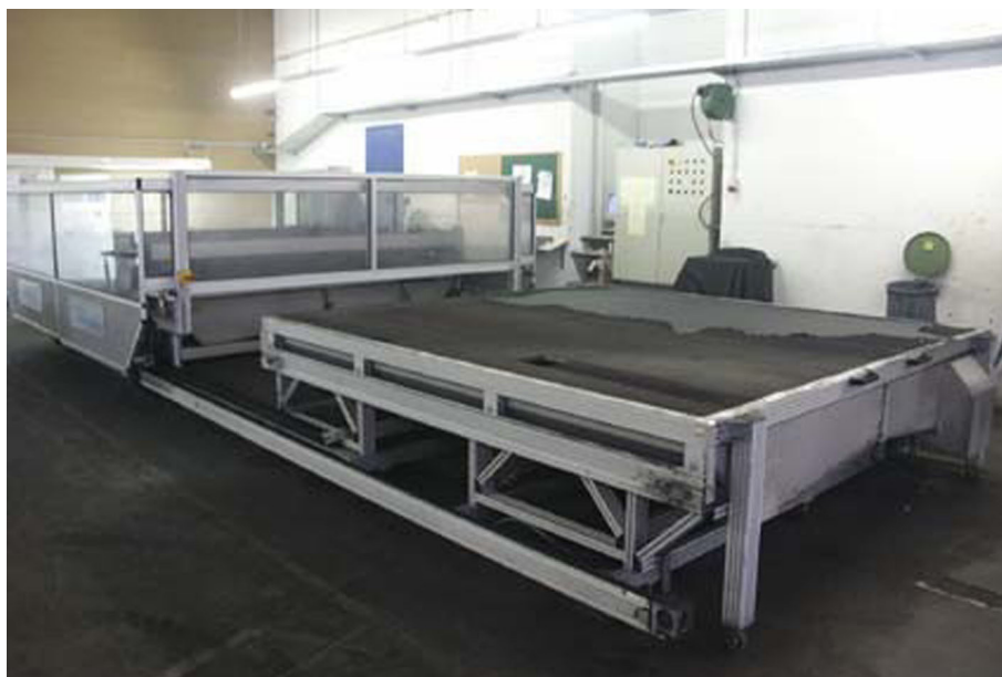
Wasserschneidanlage mit zwei Auflagetischen
