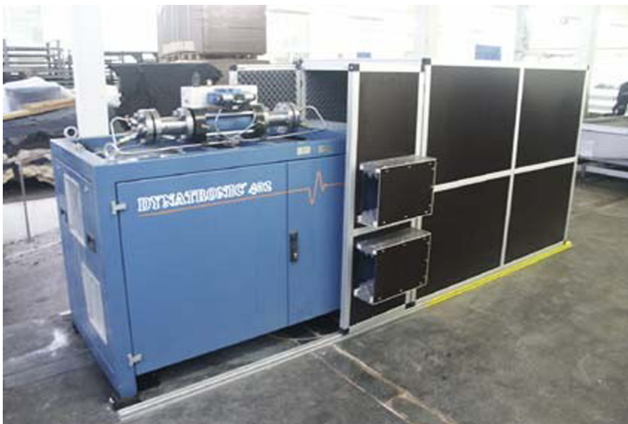
Hochdruckpumpe mit verschiebbarer Lärmschutzkapselung
