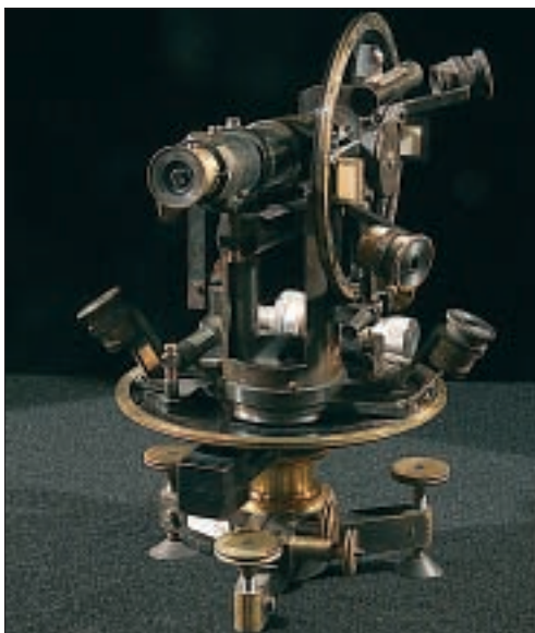
Universaltheodolith, Starke & Kammerer, Wien, 19. Jh.
