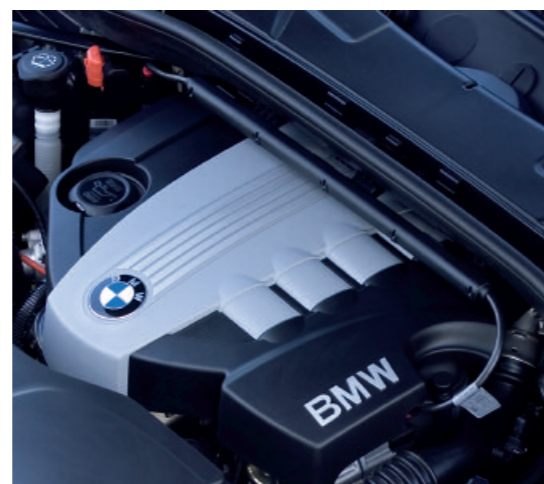
Vierzylinder-Dieselmotor mit Variable Twin Turbo im BMW 123d
