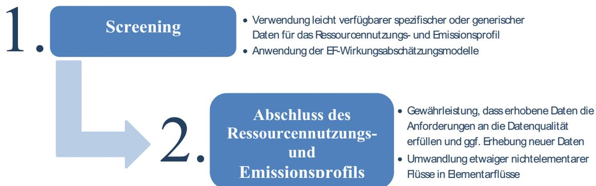
**Abbildung 3: Zweistufiges Verfahren zur Erstellung eines Ressourcennutzungs- und Emissionsprofils (das Screening wird dringend empfohlen, ist aber nicht obligatorisch).**
