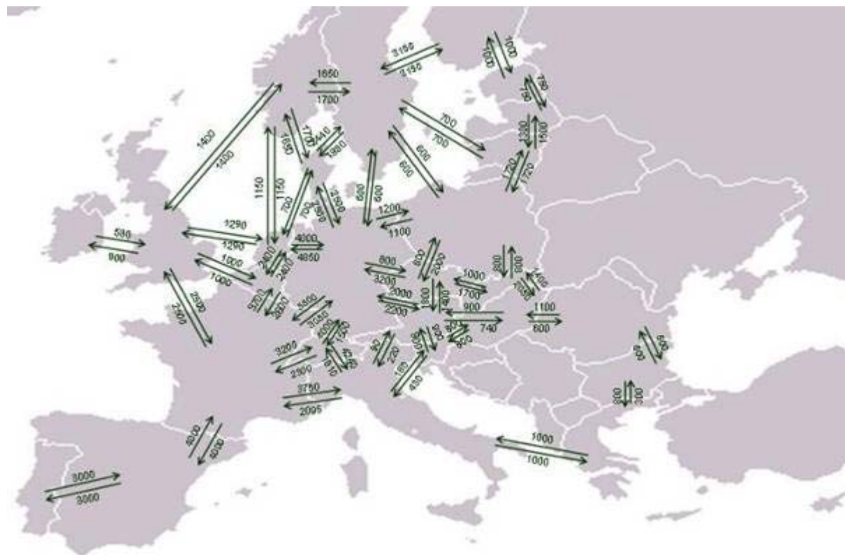
Carte 6: exigences en termes de capacité d'interconnexion en 2020 en MW 47 , scénario de référence PRIMES
