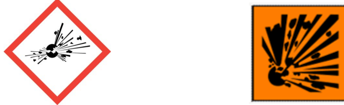
Abbildung 2: Neues (der CLP-Verordnung entsprechendes) und früheres Piktogramm für Explosionsgefahr, sehr gute Verständlichkeit für die Öffentlichkeit (über 80 %)
