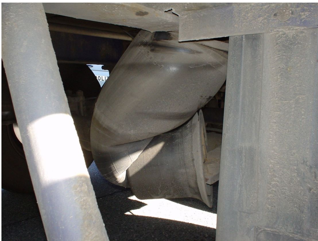
Gefahr im Verzug: gebrochene Federbalglagerung
