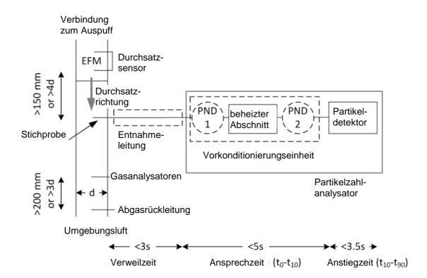
Der Partikelzahlanalysator ist über eine Probenahmesonde, die eine Probe auf der Mittellinie des Auspuffrohres entnimmt, mit der Entnahmestelle zu verbinden. Werden Partikel, wie in Nummer 3.5 von Anlage 1 erläutert, nicht am Auspuffrohr verdünnt, dann ist die Probenahmeleitung auf eine Mindesttemperatur von 373 K (100 °C) bis zu dem Zeitpunkt der
