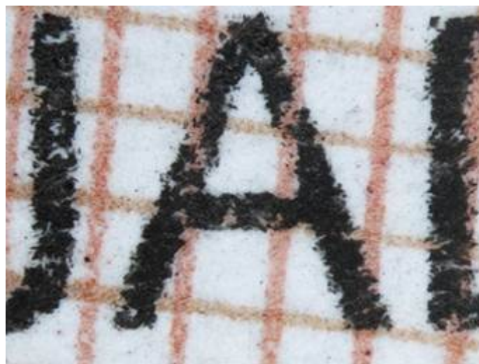
Integration der Personaldaten / des Lichtbildes mit dem Tintenstrahldruckverfahren
