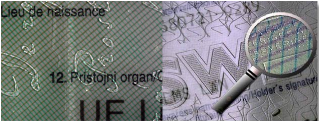
Folienprägung mit Mikrodruck
