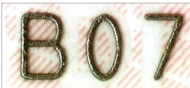
Fühlbare Lasergravur der Nummerierung
