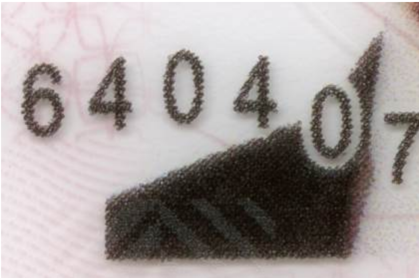
PCP-Technologie ("Polycarbonate Colour Personalisation" – Polycarbonat- Farbpersonalisierung)
