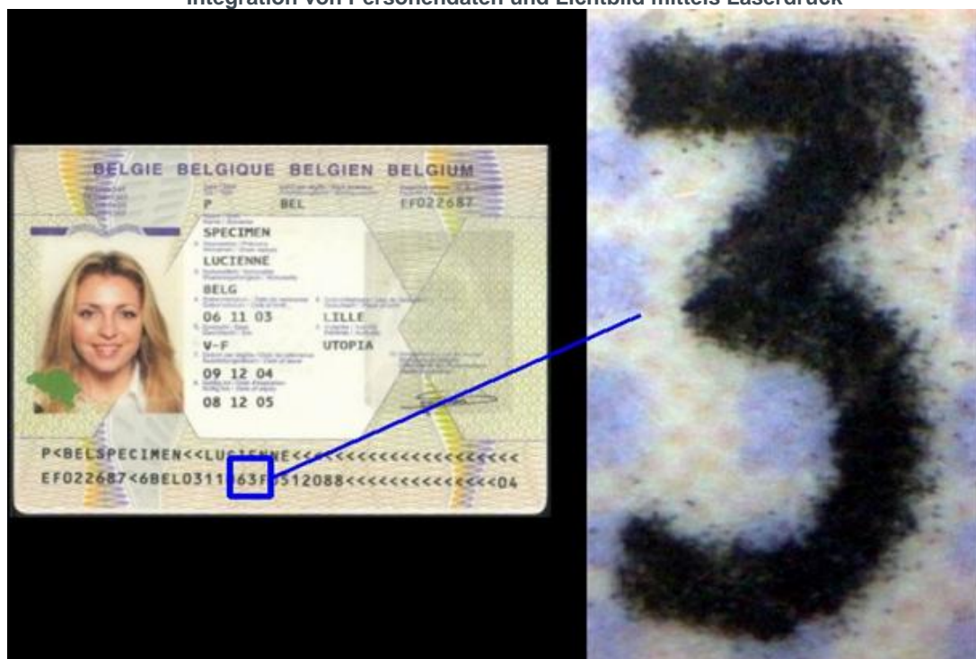
Maschinenlesbare Zone (MRZ) – Integration mittels Laserdruck
