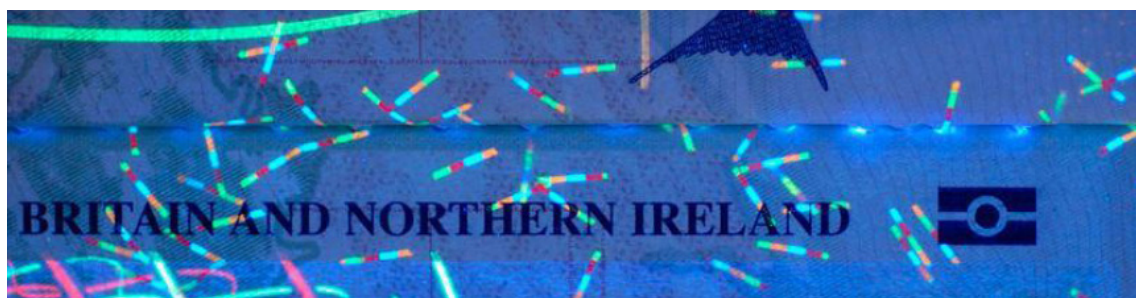
Mehrfarbige fluoreszierende Fasern
