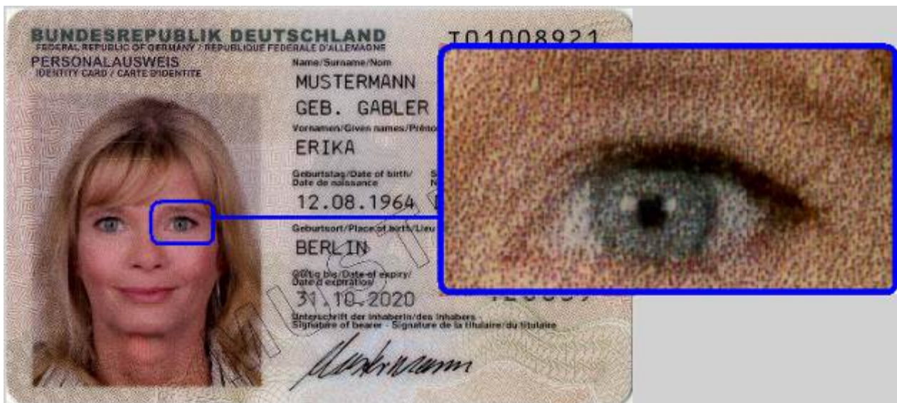
Integration des Lichtbildes in der Polycarbonat-Karte (Innosec-Fusion®-Verfahren)
