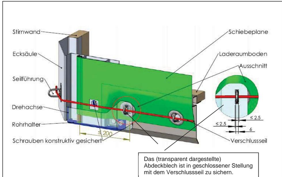
b) Engovale Öse, System gegen Anheben für das Spannrohr
