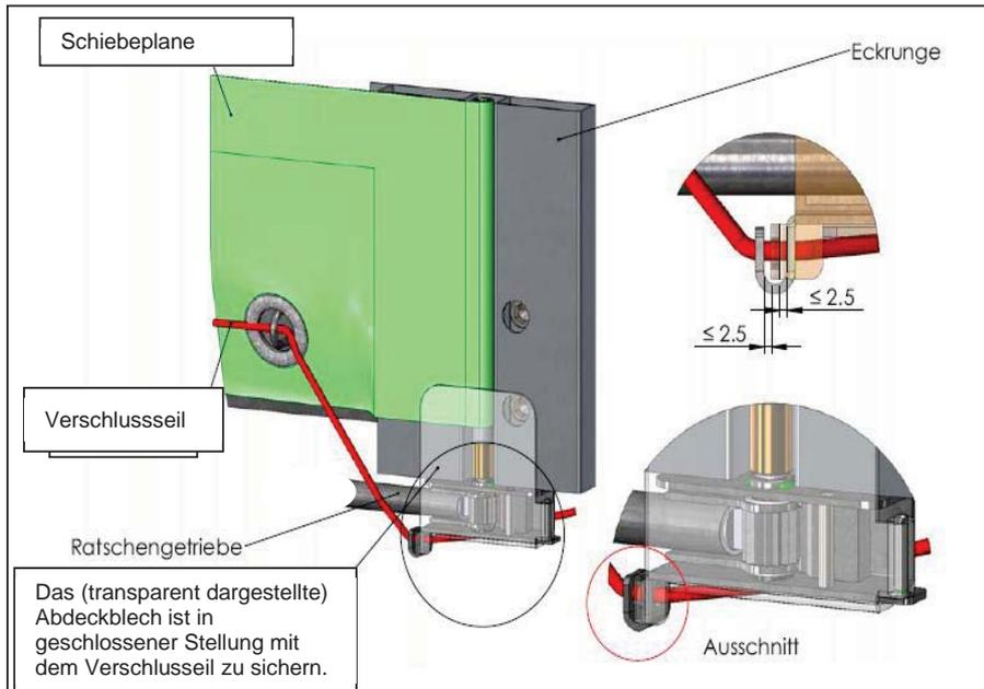
b) Sicherung des Spanngetriebes
