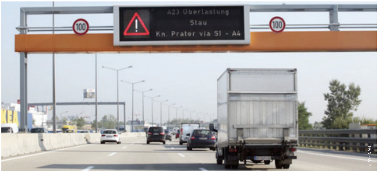
Abbildung 10: Information mittels VBA über Behinderungen auf dem kommenden Streckenabschnitt
