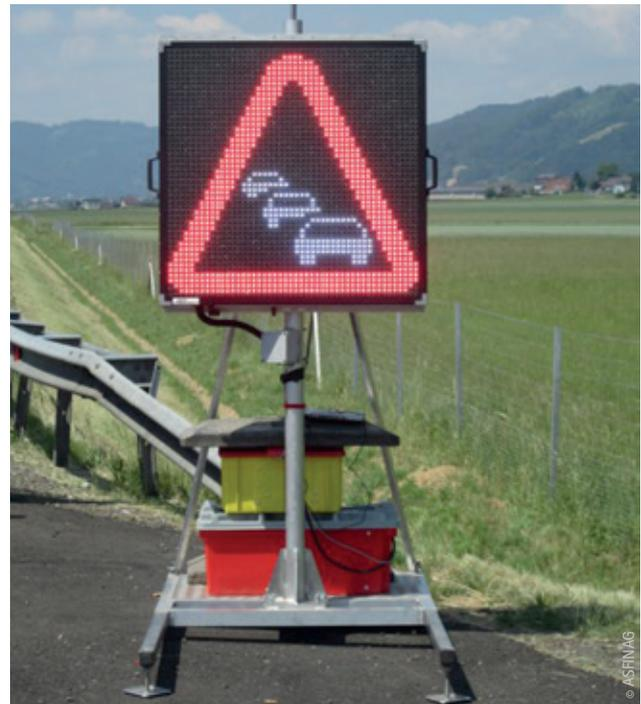
Abbildung 13: Alternierende Anzeige bei Stau (Suben A8)
