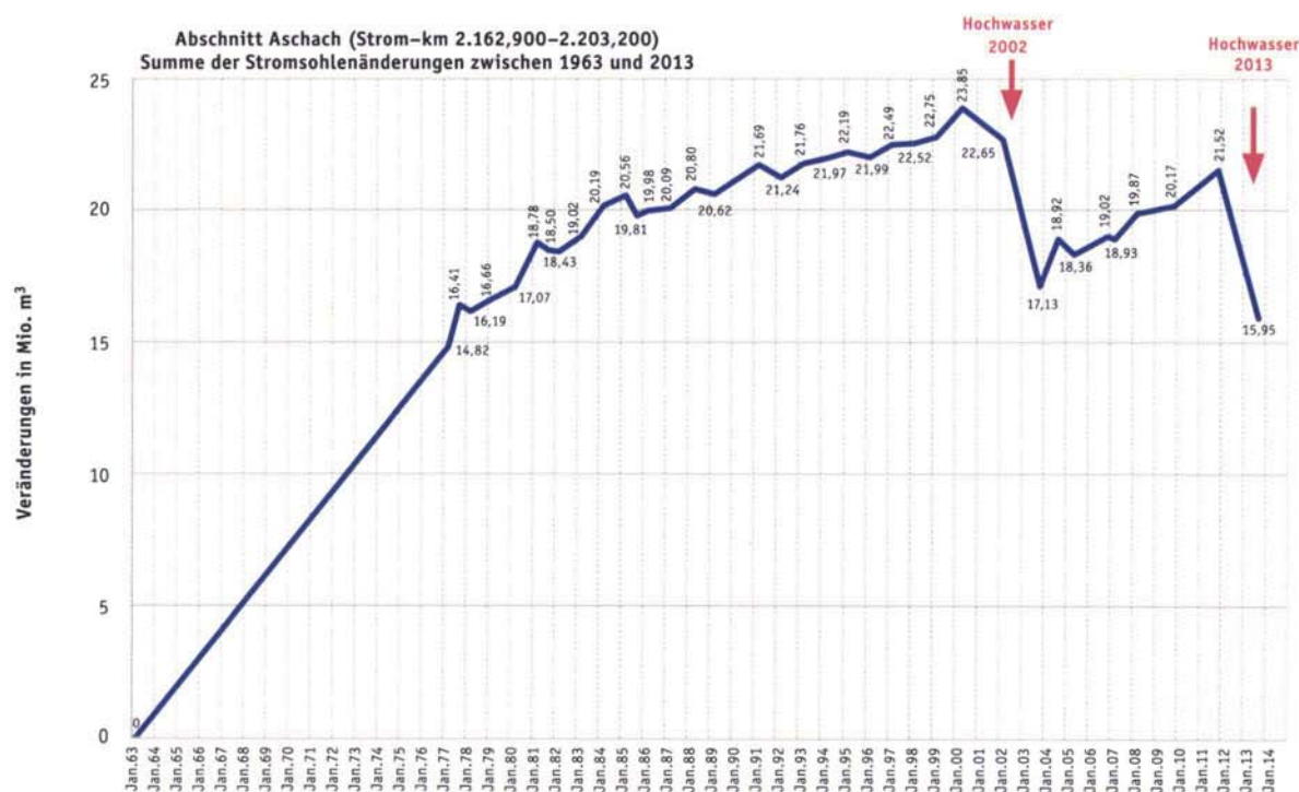
Abbildung 6: Verlauf der Stromsohlenänderungen im Stauraumbereich Aschach
