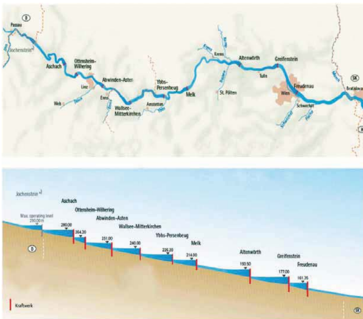
Abbildung 1: Kraftwerke an der österreichischen Donau
