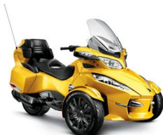
*Mit der Spurbreite von 1384 mm gilt der Can-Am Spyder als dreirädriges Kraftfahrzeug.*
