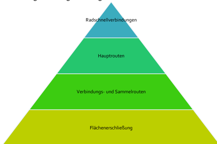
Abbildung 1: Hierarchische Gliederung von Radverkehrsnetze nach RVS 03.02.13
