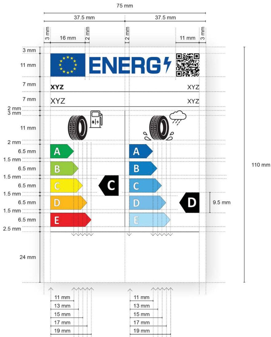
2.1.1 Format des unteren Teils der Reifenkennzeichnung für alle Reifen mit Ausnahme von Reifen, die die in der UNECE-Regelung Nr. 117 angegebenen Mindestkennwerte für die Schneegriffigkeit oder die einschlägigen Mindestkennwerte für die Eisgriffigkeit oder beide einhalten
