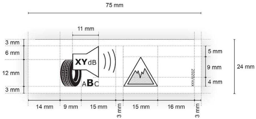
2.1.4 Format des unteren Teils der Reifenkennzeichnung für Reifen, die sowohl die in der UNECE-Regelung Nr. 117 angegebenen Mindestkennwerte für die Schneegriffigkeit als auch die angegebenen Mindestkennwerte für die Eisgriffigkeit einhalten
