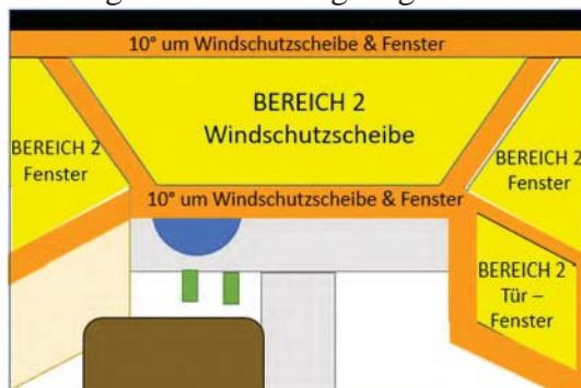
3.3.1.3. Als Bereich 3 wird jede Fläche unterhalb einer Ebene bezeichnet, die vom Augenbezugspunkt des Fahrers  $30^\circ$  nach unten verläuft, und die mit den nachfolgend beschriebenen Bereichen 1 und 2 zusammenwirkt.
