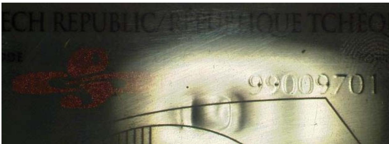
Der Mikrochip ist mit einer Antenne (einer elektromagnetischen Rahmenantenne) verbunden, die die Kommunikation mit dem Kartenleser über elektromagnetische Wellen (Radiofrequenz-Identifikation – RFID) ermöglicht. Der Chip muss sich in der Nähe des Lesers befinden, damit er mit Energie versorgt wird und die Kommunikation beginnen kann. Der geschützte Inhalt des Chips kann in einer Entfernung von 0 bis 10 cm gelesen werden.
