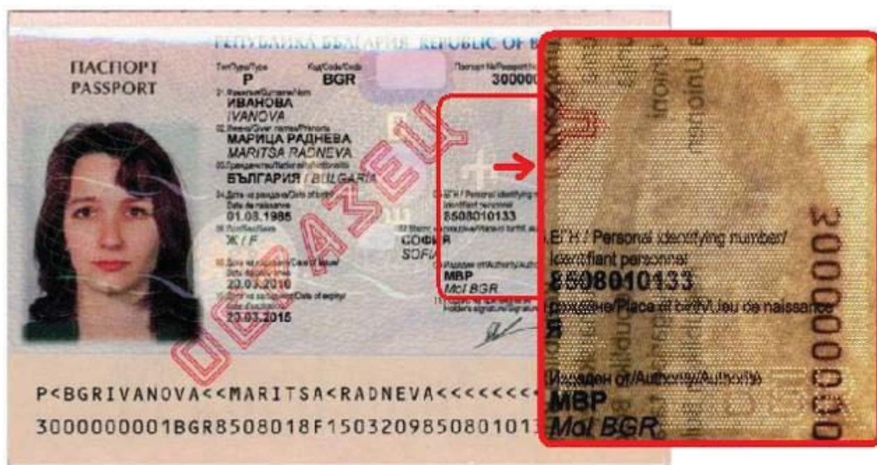
Laserperforiertes Sekundärlichtbild im Durchlicht (rechts)
