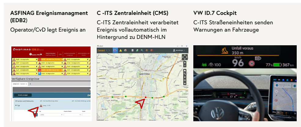
Abbildung 13: Ereigniskette – vom Verkehrsmanagement bis zur Anzeige im Fahrzeug © ASFINAG
