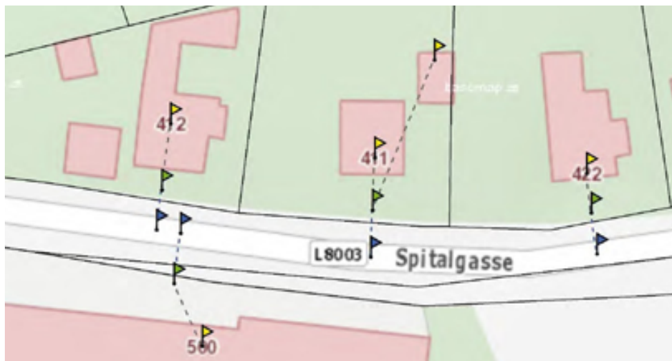
Abbildung 5: Geocodierung der Adresse mit automatisch berechneter Zufahrts- (grün) und GIP- (blau) Koordinate und unveränderter Geocodierung der Gebäude (gelb)
