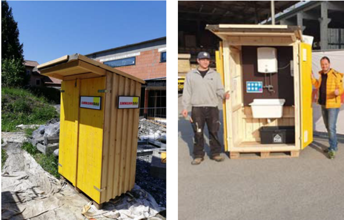
Abb. 4: Mobile überdachte Waschgelegenheit mit warmen fließenden Wasser auf Baustellen
