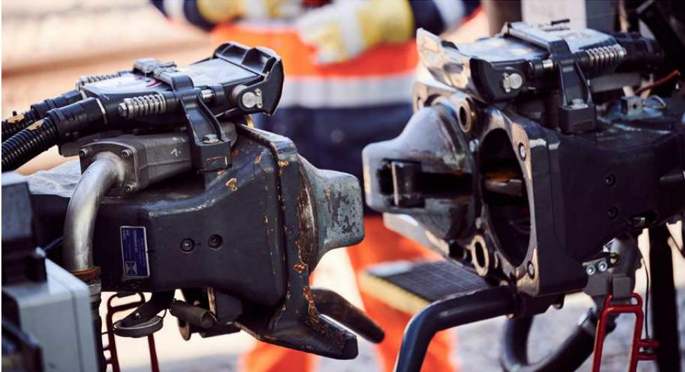
Abbildung 2: Digitale automatische Kupplung (DAK) © ÖBB
